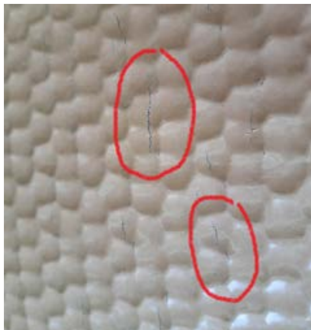
Silikonpapier nach ca. 2-maliger Verwendung (kleine Risse erkennbar)
